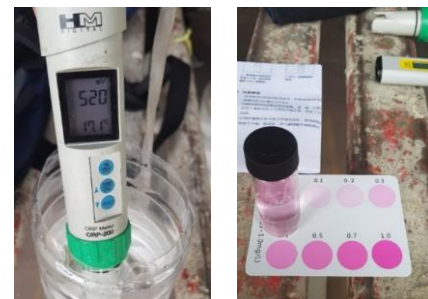
Gambar 3. Pengecekan Kandungan Ozon Dalam Air
